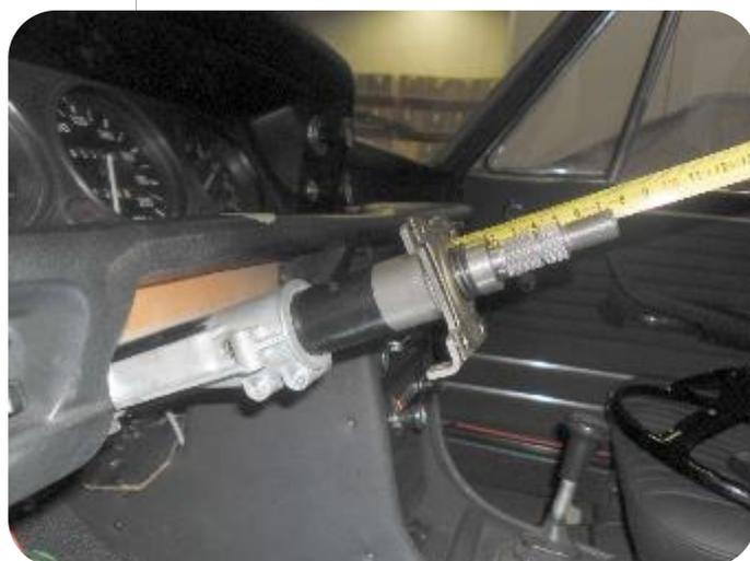
Controllare la lunghezza di proiezione dell'albero dello sterzo misurata al punto 23. Se necessario, regolarla facendo scorrere il tubo di sterzo superiore nell'unità EZ. Quindi fissare la colonna. Non dimenticare di fissare il piantone dello sterzo (vedi punto 12).
