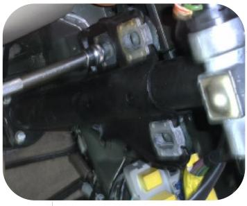
Entfernen Sie die Lenksäule. Entfernen Sie die zwei Bolzen in der Halterung unter dem Armaturenbrett und die drei Bolzen im Flansch an der Stirnwand.
