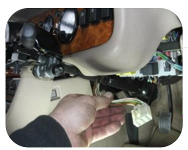
Schritt 5. Lösen Sie die zwei Stecker die von der Lenksäule kommen.
