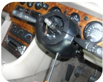
Schritt 4. Lösen Sie die Abdeckung des Blinkerhebels.
