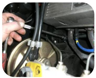
Schritt 6. Lösen Sie den Bolzen im Kreuzgelenk im Motorraum.
